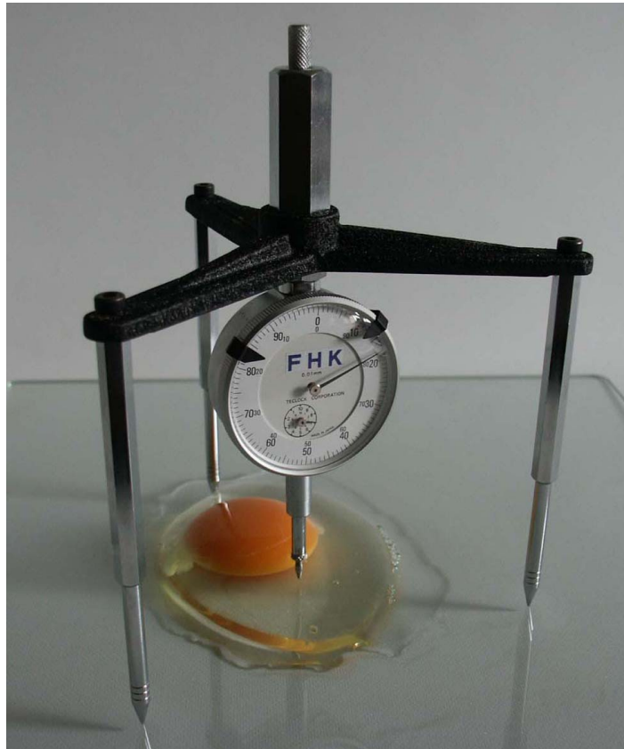
図 6-7 ハウユニットの測定
